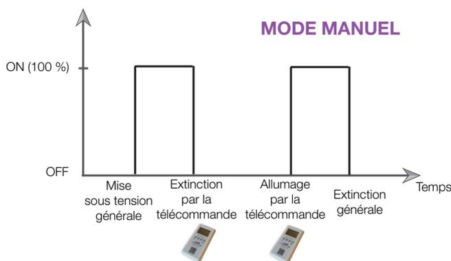
Contrôleur ON/OFF communiquant en **radio**, le SLswitch permet une **gestion précise des illuminations**: activation de la programmation, paramétrage du temps d'illumination, gestion du nombre de jours d'illuminations...
