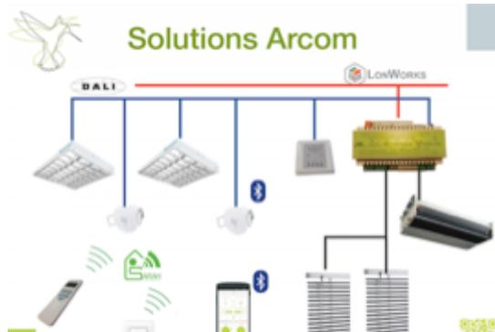
**Côté technique :** les réalisations d'ARCOM, développées sur la base de **protocoles de communication ouverts et interopérables (LonWorks®, Dali, Sarah)** offrent une **flexibilité inégalée** en cas de nécessité d'adaptation.
