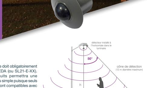
Le détecteur de présence Citylone doit obligatoirement être associé à un produit SL-XX-EDA (ou SL21-E-XX). L'association de ces deux produits permettra une installation homogène et efficace, très simple puisque seuls 2 fils sont à câbler. Ces détecteurs sont compatibles avec les solutions autonomes, pilotées et télégérées.
