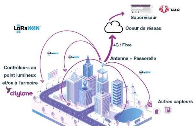
La **gamme LoRaWAN**, permettant des communications radio longue distance est particulièrement adaptée aux installations avec des points lumineux éparpillés ou isolés. Elle est également capable de **collecter d'autres données** telles que celles des compteurs électricité, eau et gaz, en plus des informations concernant l'éclairage public.
